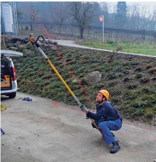
17 Seilwurfsystem mit Industrieschleuder
